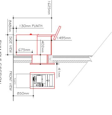
(KEYPAD HEIGHT SHOULD BE BETWEEN 850mm - 1000mm) EXAMPLE SECTION
